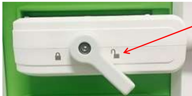
Figura 29: Manopola di bloccaggio sul connettore del trasduttore sbloccata
